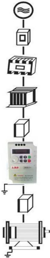
图 3-1 与外围设备的连接图
