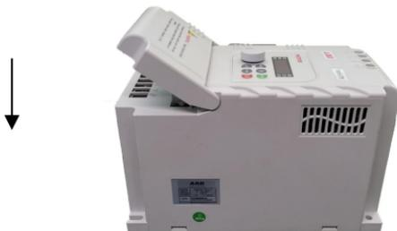
图 2- 4 安装端子外罩
