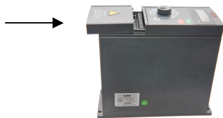
图 2-8 安装端子外罩
